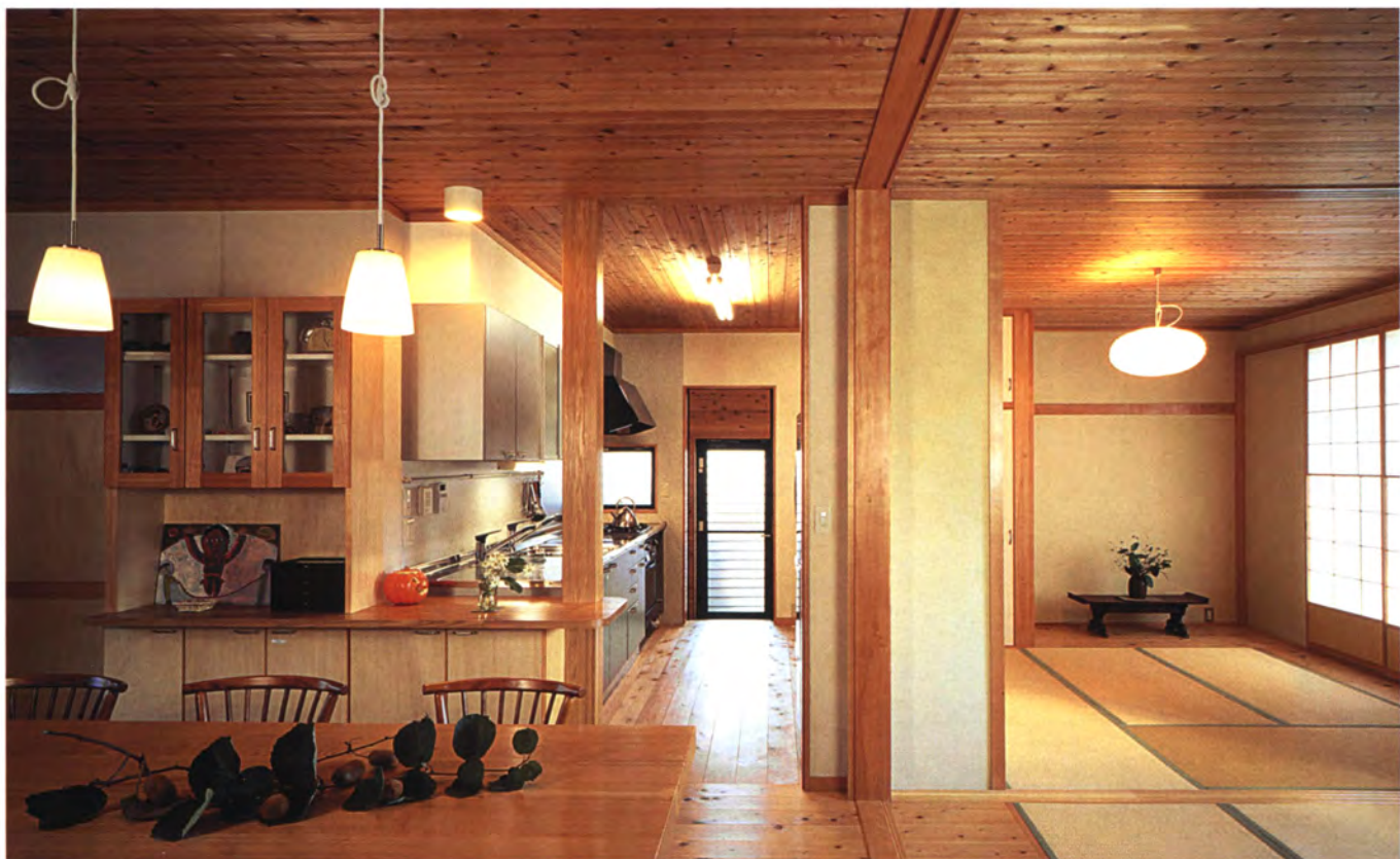
▲食堂から台所・和室を望む 暗かった室内は、引き込み戸を多用し、明るく開放的にした。
